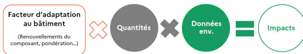
Figure 29 - Principe de calcul des impacts environnementaux de la RE2020, issu de (Cabassud, et al. 2020).
