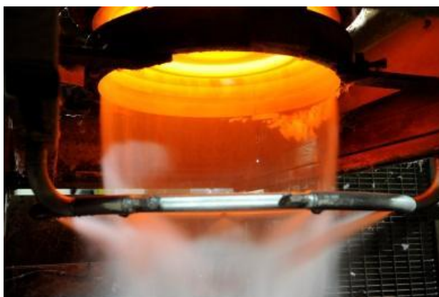
Illustration 3 : Production de fibres de verre isolantes après extrusion (Source : ISOVER)
