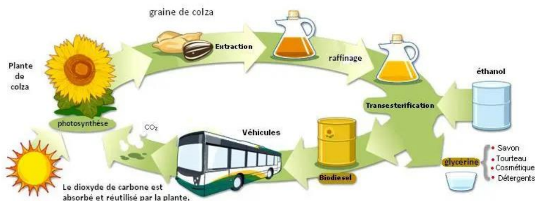
Figure 32 – Le cycle du biodiesel à partir de graines de colza, issu de (Eppherre, Perez and Berrogain 2012).
