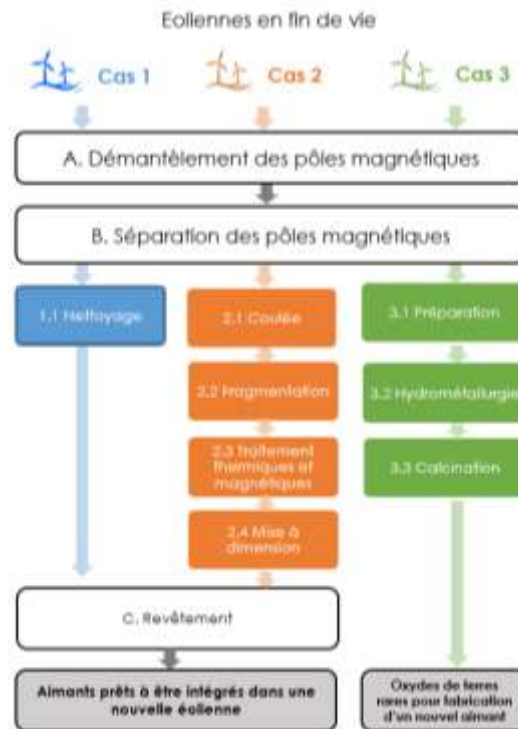
Figure 2: Etapes des trois boucles de valorisation des aimants permanents en fin de vie
