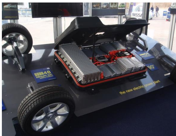
Figure 60 : Maquette d'implantation du pack NMC dans une Nissan LEAF
