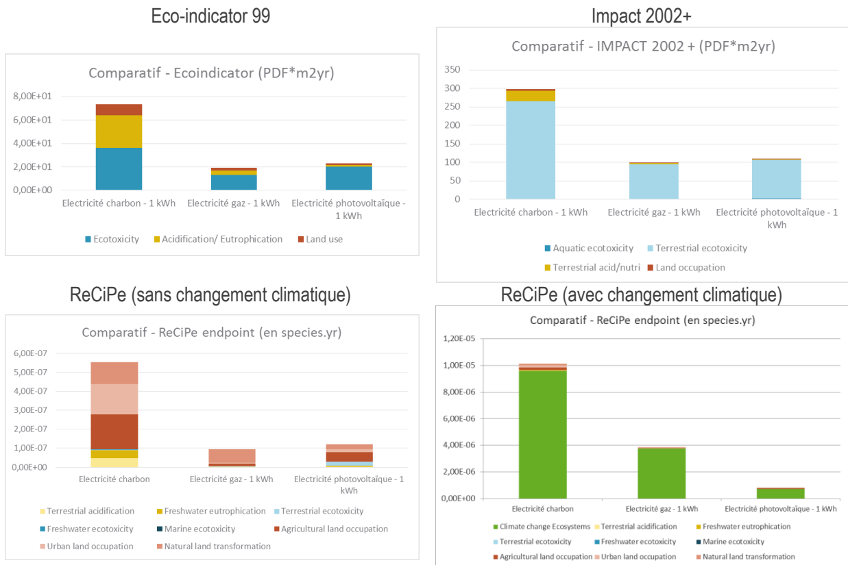
Figure 16 : Comparaison des résultats pour le endpoint « Qualité de l'écosystème » des trois sources d'énergie selon les trois méthodes ACV
